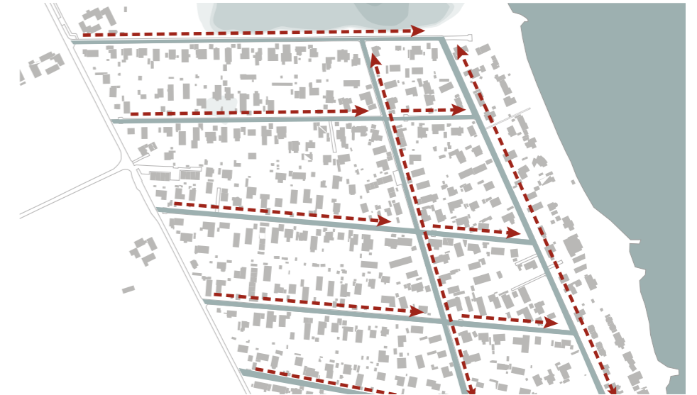
LØSNING – Veje opdeler Søvang i enklaver og håndterer det regnvand, der falder på vejen, hvor det forsinkes indtil udløb til pumpestation er muligt.
