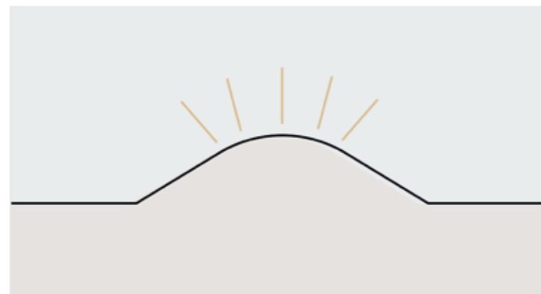
Digets top er hellig, både af tekniske og af visuelle grunde. Teknisk set er digekronen både vigtig, fordi højden skal fastholdes og sårbar, fordi græsset armerer jorden og derfor ikke må slides af.
