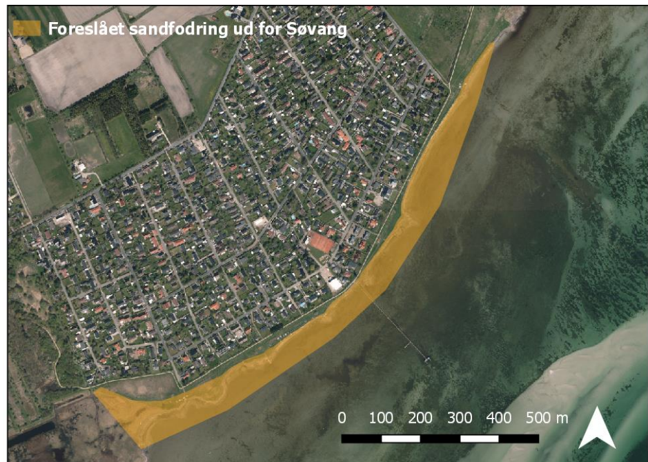
Figur 10.1: Omtrentligt omfang af foreslået område til sandfodring, op til kote +1,2 m DVR90 foran Søvang, for at reducere kronekoten af diget.
