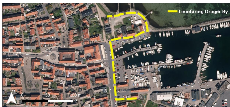
Figur 5.5: Anbefalet linieføring af stormflodssikring i form af skråningsbeskyttelse langs den nordlige yderside af havnen samt en højvandsmur med porte bag inderhavnen. Baggrundskort: Orthofoto 2016, Geodatastyrelsen, WMS-tjeneste.
