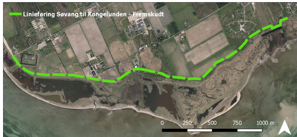
Figur 5.16: Anbefalet linieføring af diget mellem Søvang og Kongelunden i form af et fremskudt kystdige. Baggrundskort: Orthofoto 2016, Geodatastyrelsen, WMS-tjeneste.
