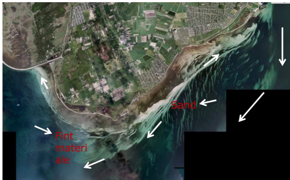
Figur 3.2: Den overordnede dominerende materialetransport langs kysterne omkring Dragør Kommune markeret med hvide pile. I nogle tilfælde går transporten fra vest mod øst dog også rundt om Af-landshage. Baggrundskort: Orthofoto 2016, Geodatastyrelsen, WMS-tjeneste.
