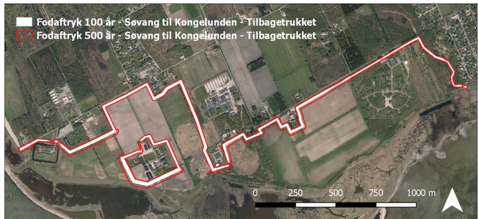
Figur 5.23: Resulterende fodafttryk/udbredelse af anbefalet tilbagetrukne kystdige mellem Søvang og Kongelunden til beskyttelse mod højvande med 100 års returperiode i år 2050. Baggrundskort: Orthofoto 2016, Geodatastyrelsen, WMS-tjeneste.
