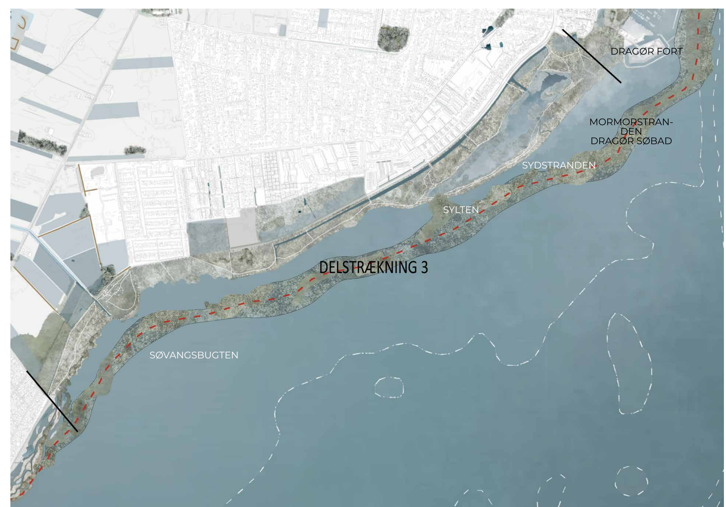
Illustrationen viser med stiplede linje, hvor et fremtidigt forland kan ligge på delstrækning 3. En sådan ydre løsning på denne strækning, vil sandsynligvis først blive anlagt efter 2050 (ill: Arkitema og COWI)
