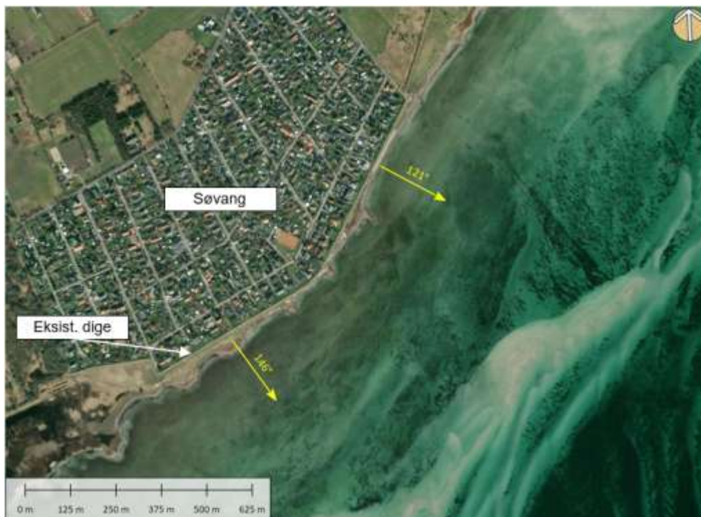
Figur 2-8 Kystorienteringer af eksisterende kyst. Bølgeforholdene ved kysten er stærkt afhængige af sandbankerne ca. 500 m foran kysten.
