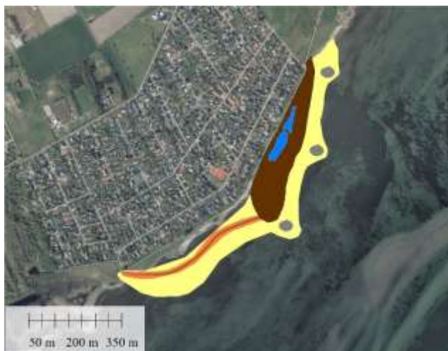
c) Indpumpning af marint sand er afsluttet og pumpeledning demobiliseret. Gravning af rende, etablering af lærkerne samt stenafdækning af lærkerne forløber parallelt bag inddæmningen af det indpumpede sand. Ren overskudsjord (mørkebrun) tilføres over kote +1,0 og søer (blå) udgraves. Udgravet materiale fra søerne genindbygges på kystforlandets bagside. Stenflak (grå) etableres løbende.
