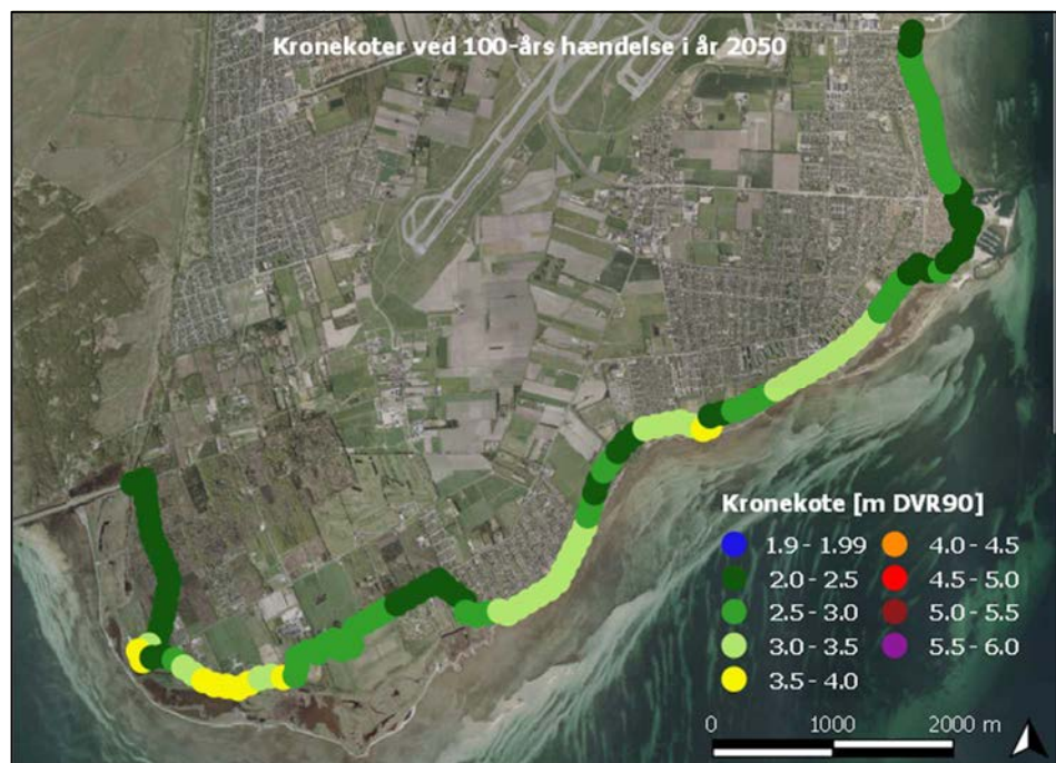
Figur 3.2: Anbefalet kronekote for højvandsbeskyttelse imod en 100-års stormflodshændelse i år 2050.
