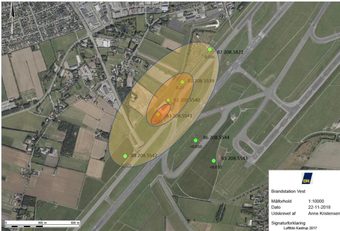
Figur 7.3 Forureningsudbredelse i toppen af kalken. Koncentrationerne er angivet i \mu\text{g } \Sigma 12 \text{ MST PFAS /l} .
