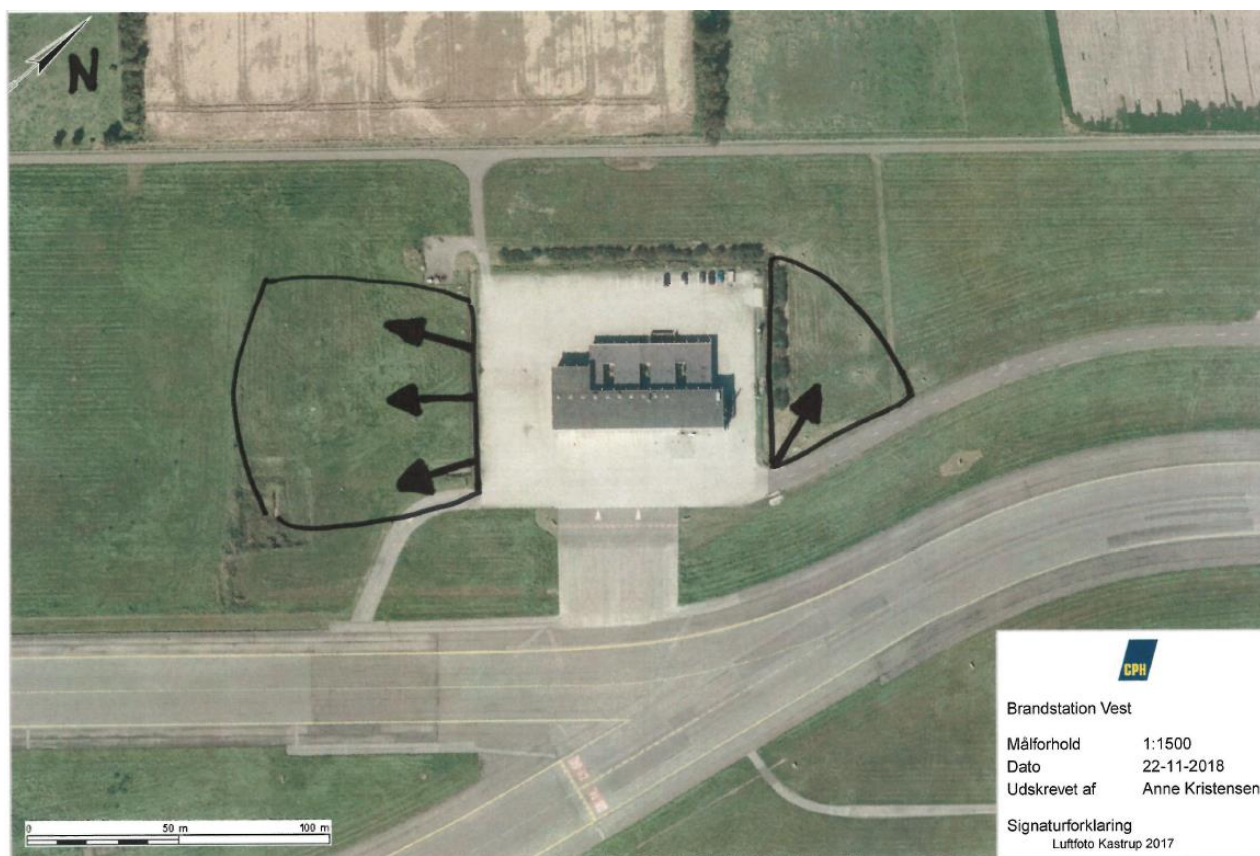
Figur 2.1 Skumafprøvning hver mandag ved Brandstation Vest. Markeringerne viser, hvor brandslukningsskummet blev sprøjtet ud i perioden 1972-1998.
