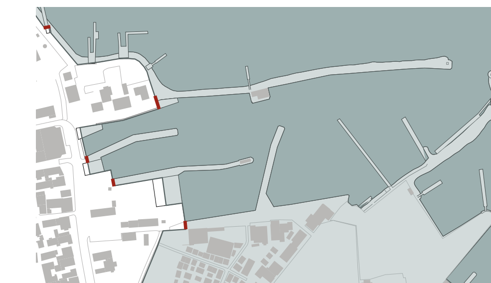
SIKRING - ved hændelse Der sikres op til kote 2.00 med mobile løsninger
